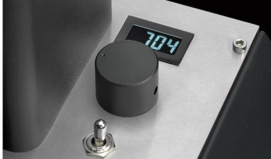
Mittels des Kippschalters wird das Bias Messverfahren aktiviert. Der 4-stufige Drehschalter darüber verknüpft die jeweils 4 Röhren mit dem darüber liegenden Messinstrument
