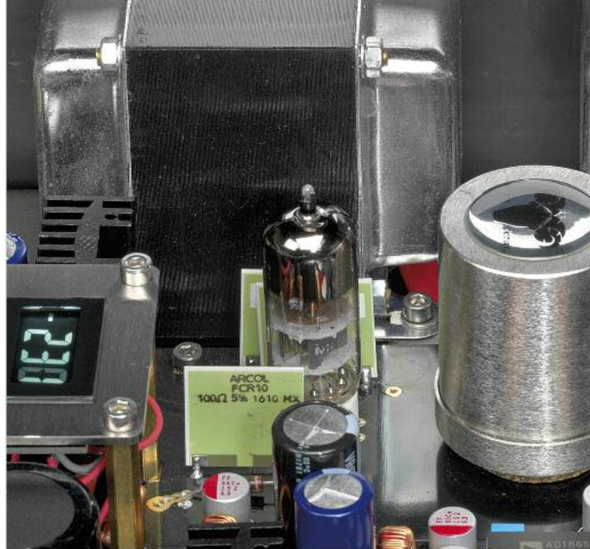
Dicke EI-Kern-Trafos versorgen kanalgetrennt die Röhrenausgangsstufe, speziell gekapselte Übertrager sorgen für eine niedrige Ausgangsimpedanz von 100 Ohm
