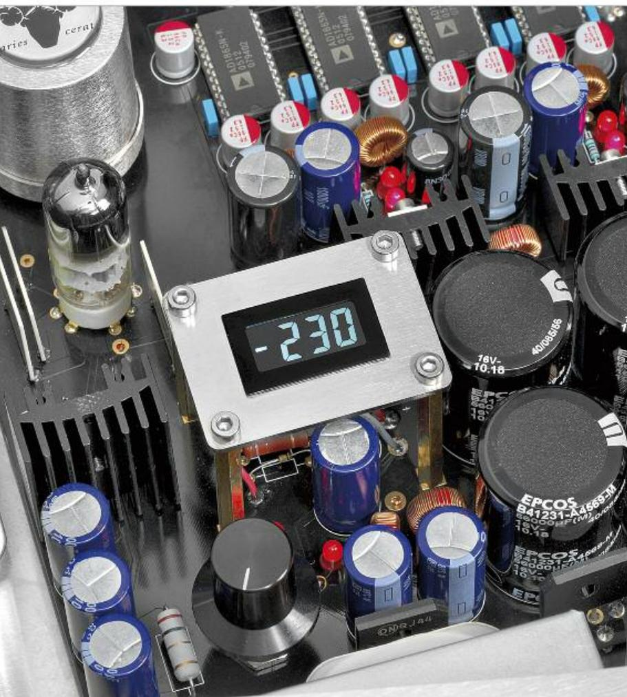
Oben: Die Siemens E280F weist eine extrem hohe Bandbreite bei sehr langer Lebensdauer auf und stammt ebenso wie der Gleichrichter vom Typ GZ34 aus NOS-Beständen
