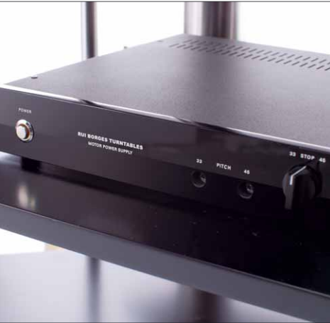
Die ausgezeichnete Motorsteuerung, die Joaquín Pinto, ein Freund von Rui, entwickelt hat. Borges lötet sie aber selbst
